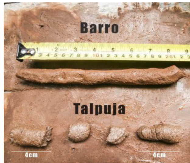
Fig. 10. Foto de la prueba # B realizada Fuente: Propia
