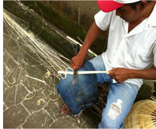
Fig. 8. Foto de la extracción de fibras de bambú obtenidas artesanalmente. Fuente: propia
