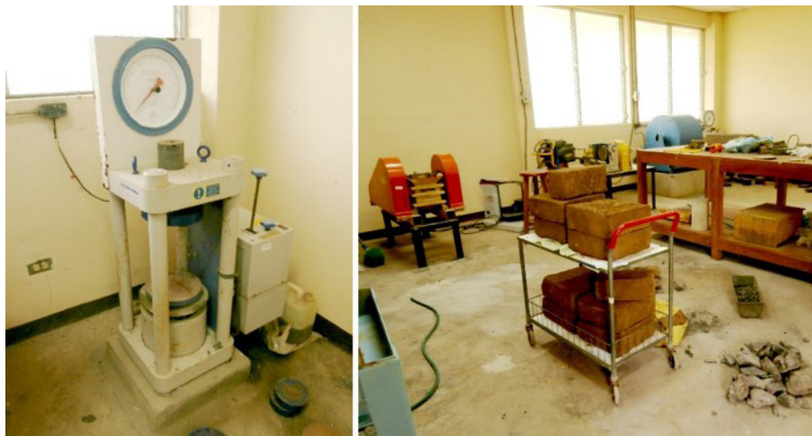
Fig.13. Máquina de ensayo de resistencia a la compresión simple en el laboratorio de suelos del Instituto de Geología y física IGG-CIGEO de la UNAN-Managua.
