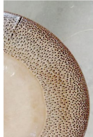
Fig. 7. Sección transversal de la pared del culmo. Fuente: Propia
