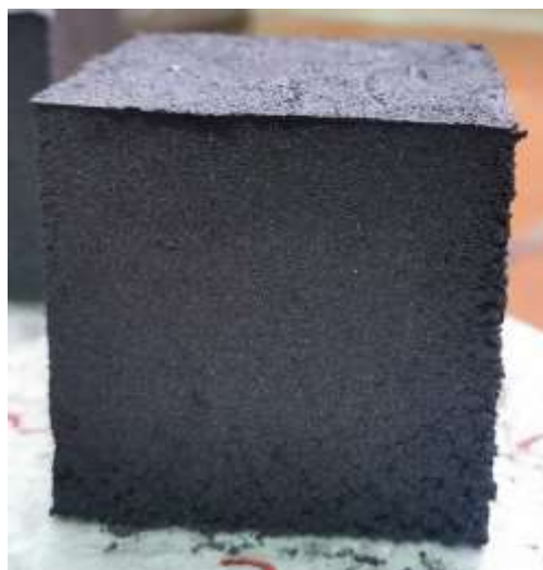
Figura 1. Producto cemento supersulfatado a partir de ceniza de bagazo de caña, cal y sulfato de calcio
